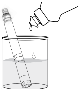
Figura 72 Limpeza de sensor de pH e pH/ORP com detergente para loiça
