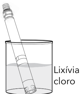
Figura 74 Limpeza do sensor de pH e pH/ORP com lixívia à base de cloro
